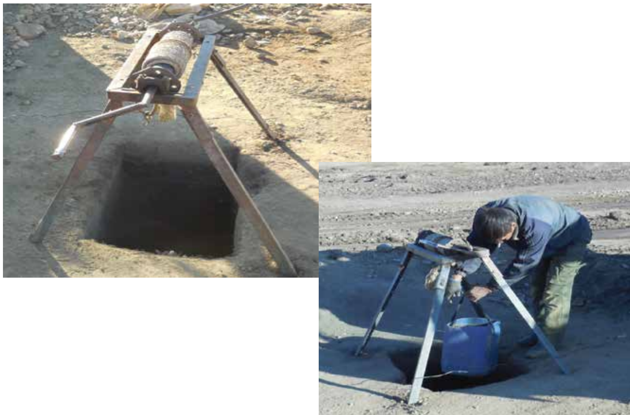
Зураг 2. Шарын гол суман дах алтны бичил уурхайд хэрэглэж буй гар хийцийн багаж Photo 2. Handmade tool used by Artisanal gold miners in Shariin-Gol soun, Darkhan-Uul aimag
